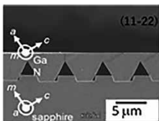
図3 山口大学オリジナルの非極性面Ga 2 Nの断面SEM像
